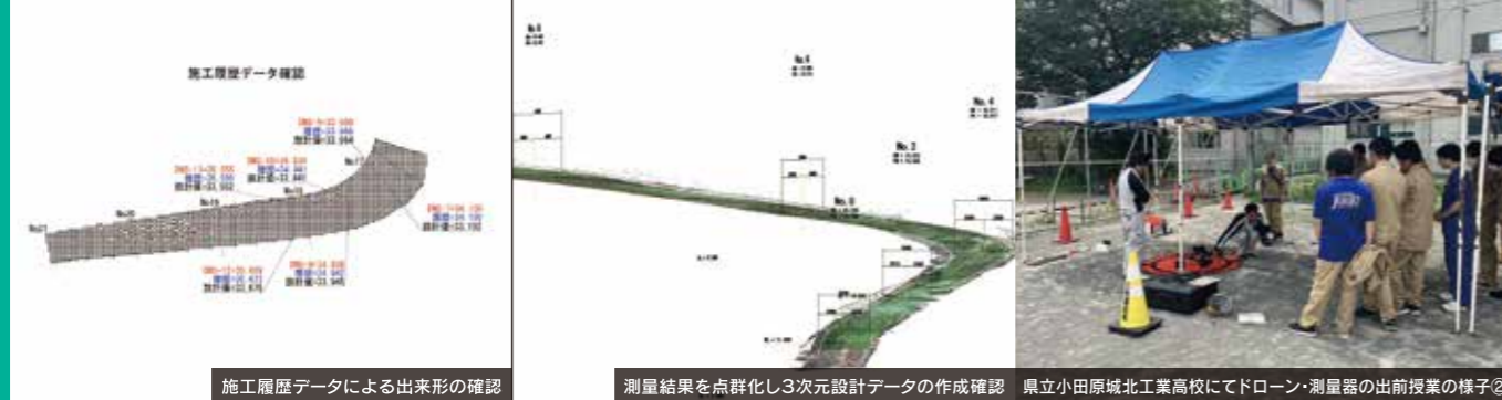
施工履歴データによる出来形の確認
