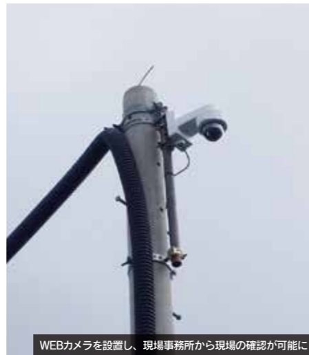
WEBカメラを設置し、現場事務所から現場の確認が可能に
